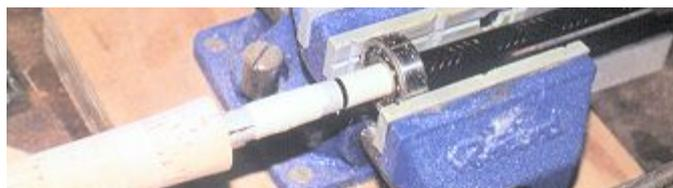
> Le blank est recouvert de ruban adhésif papier pour le protéger et pour lui permettre de rentrer en force (sans exagérer) dans le roulement à bille. Le roulement à bille est serré dans l'étau sans excès pour ne pas le déformer ce qui entraînerai le blocage de celui-ci.
