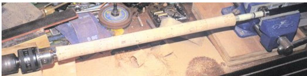
> Si on prend soin de bien aligner tout ce bazar, tout devrai bien se passer. La vitesse de rotation ne doit pas être trop élevée, le liège étant un matériau possédant un faible coefficient de dissipation thermique, la température est susceptible de monter rapidement...
