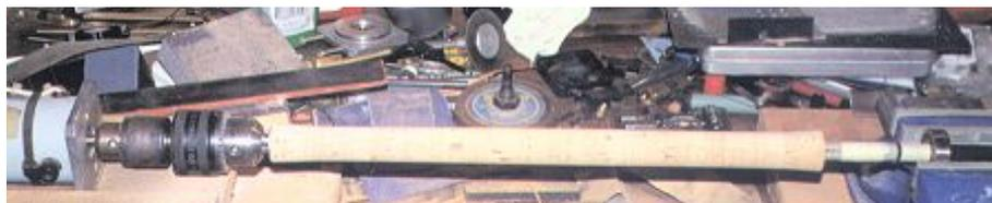
> L'essentiel consiste en peu de choses, un moteur (ici on solide moteur d'une vieille imprimante associée à un mandrin pour perceuse, sinon une perceuse peut convenir mais c'est moins facile à stabiliser), un gros roulement à bille (un roulement avec moyeu orientable c'est encore mieux) et un petit étau mobile.
