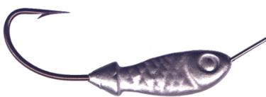
> Après démoulage il est conseillé de ne pas perdre de temps avant d'entamer l'étape de la mise en peinture pour éviter des problèmes d'oxydation.
